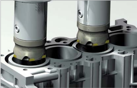
Perforación de cilindro(Desbaste) - Cortador de barrenar
