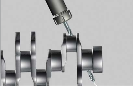
Estructura de Taper Spline (Rigidez mejorada por el área de contacto aumentado)
