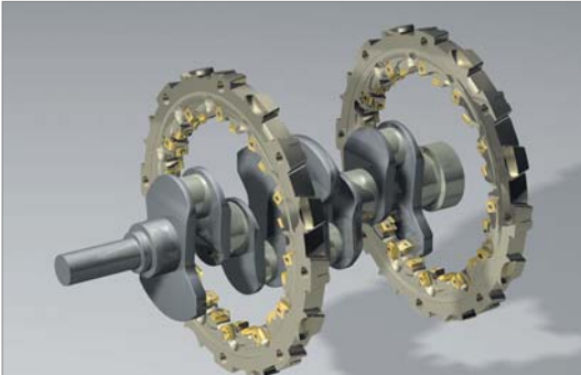
Cortador del Cigüeñal (Interno y Externo)
