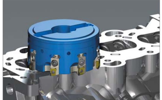
Cara Superior (Desbaste y Acabado) - Aero Mill
