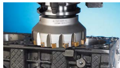
Desbaste en Fundición
