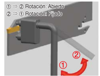
③ Gire la llave nuevamente a la posición original para fijar la placa
